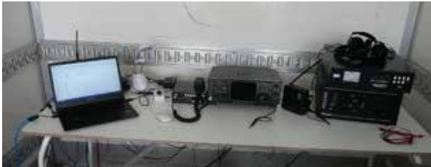
Die defekte Station. In der Mitte der ICOM IC756PRO, rechts die RFPower Linear und darüber der MFJ Antennetuner
