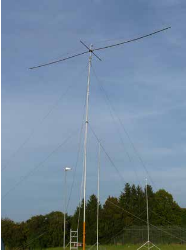
Im Vordergrund der Rotary-Dipole, rechts dahinter die 160m/80m Antenne und weiter hinten rechts der 40m Dipol
